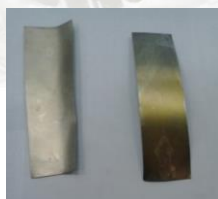
Ezüstözött rézlemezek frissen készítve (bal) és idővel elsárgulva (jobb)
